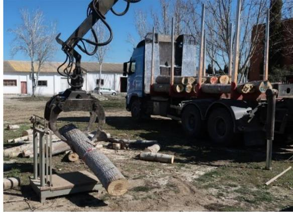
Figura 3.2.3: Pesada de trozas con báscula industrial.
