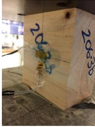
Figura 3.2.7: Ensayo a compresión perpendicular de la fibra.
