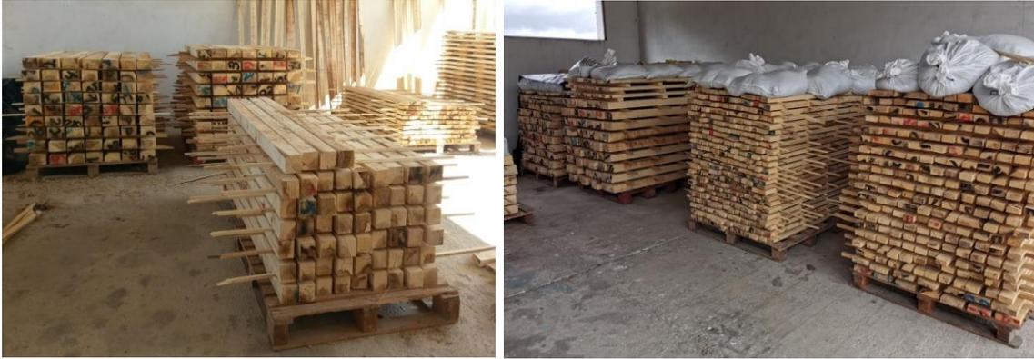
Figura 3.1.7: Colocación y enrastrelado de las diferentes piezas para el secado al natural.
