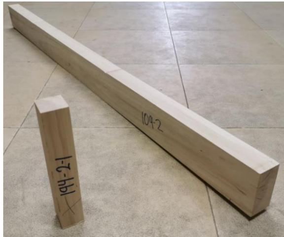
Figura 3.1.8: Imagen de una probeta para ensayo a compresión (izquierda) y una viga para ensayo a flexión (derecha).
