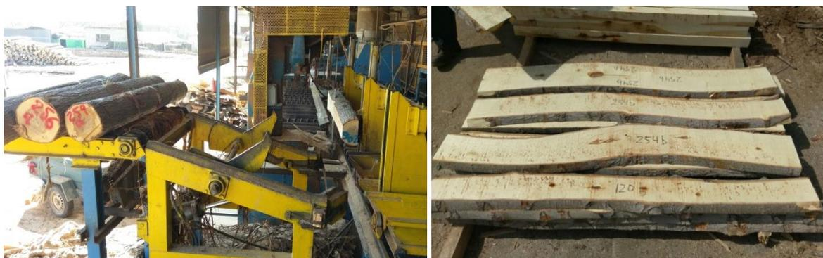
Figura 3.1.6: Aserrado de trozas. Izq.: Corte de las trozas en la sierra de cinta. Der.: Agrupación por lotes y numeración de cada pieza aserrada.
