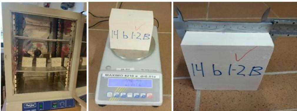
Figura 3.2.8: Proceso de secado, obtención de masas y probetas de densidad.
