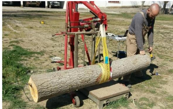
Figura 3.2.4: Medida de la velocidad de propagación de ondas elásticas en troza mediante el método de resonancias.
