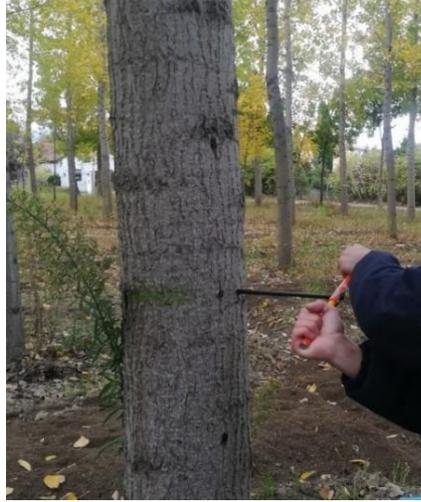
Figura 3.2.1: Extracción de una muestra en árbol en pie mediante barrena Pressler.
