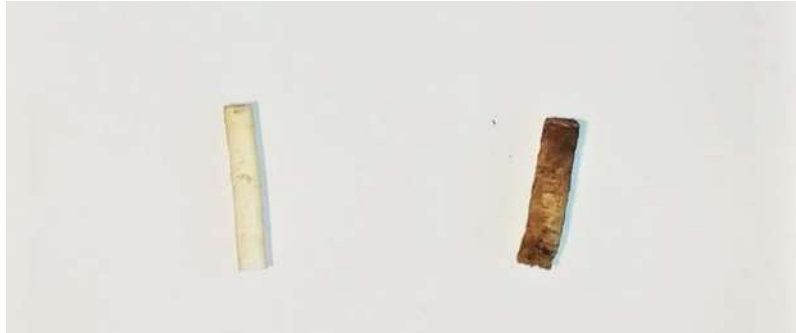
Figura 13. Ejemplo de muestras extraídas con barrena de chopo (izda.) y nogal (dcha.)
