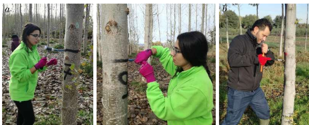
Figura 12. Proceso de extracción de las muestras para la determinación de la densidad en verde. a: Utilizando la barrena de Trephor35 en chopos. b: Utilizando la barrena de Pressler en nogales
