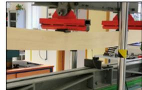
ENSAYO EN MADERA ASERRADA
